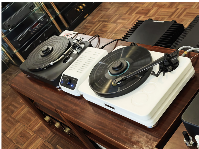
● Model 8與Model 6合照，可以看出Model 8的底座與轉盤都比後者更厚，整體重量提升達40%。
